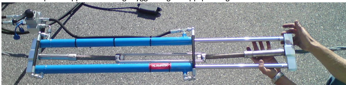
Figur 5. Dragok placerat över uppspänningspanelen. När korrekt uppspänningskraft uppnåtts låses panelen med muttrarna.
